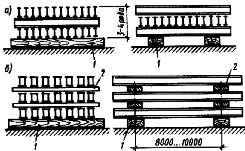
Рис.8. Складирование стальных элементов конструкций в многоярусных штабелях:
