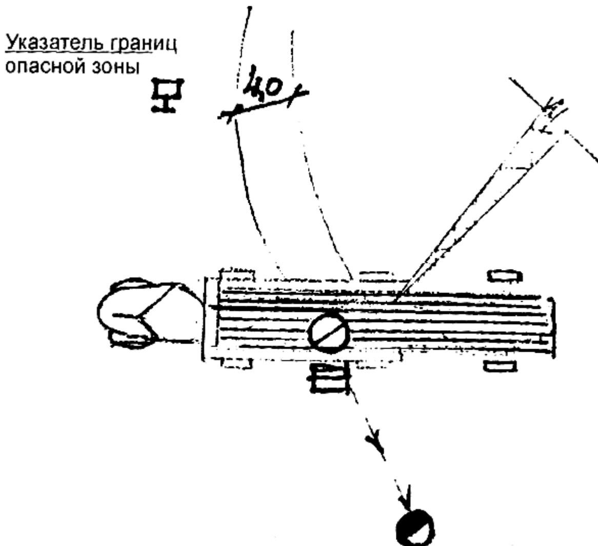
Рис.9. Организация рабочего места на разгрузке с автомашины
