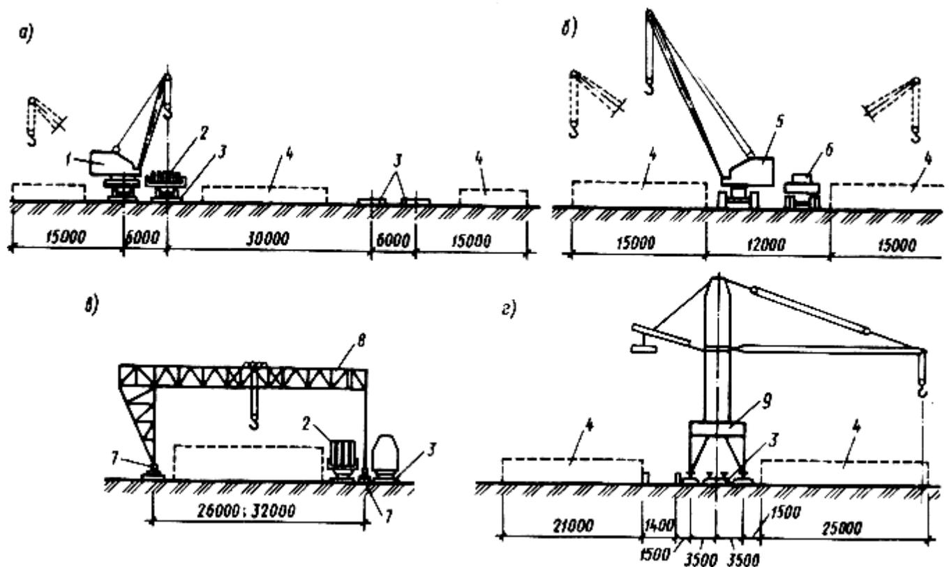
Рис.6. Схемы приобъектных открытых складов, обслуживаемых разгрузочными кранами:
